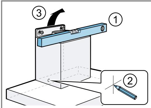
4. Пробийте отвор за фиксирация винт с диаметър 8 mm и дълбочина 80 mm и притиснете дюбела пътно до стената. ①
